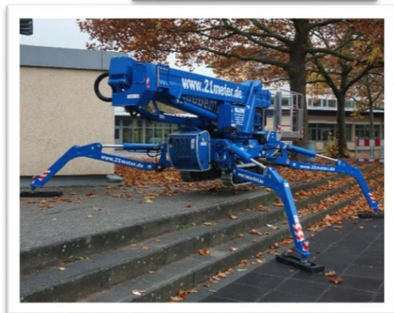
Abstützung mit 1,20 Meter Höhenausgleich
